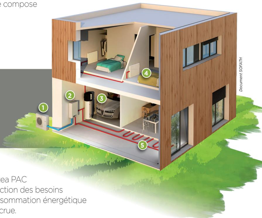
Dotée de la technologie Inverter, la gamme Lizea PAC adapte sa puissance automatiquement en fonction des besoins de chauffage. A la clé, une réduction de la consommation énergétique de l'appareil et une durée de vie du produit accrue.
